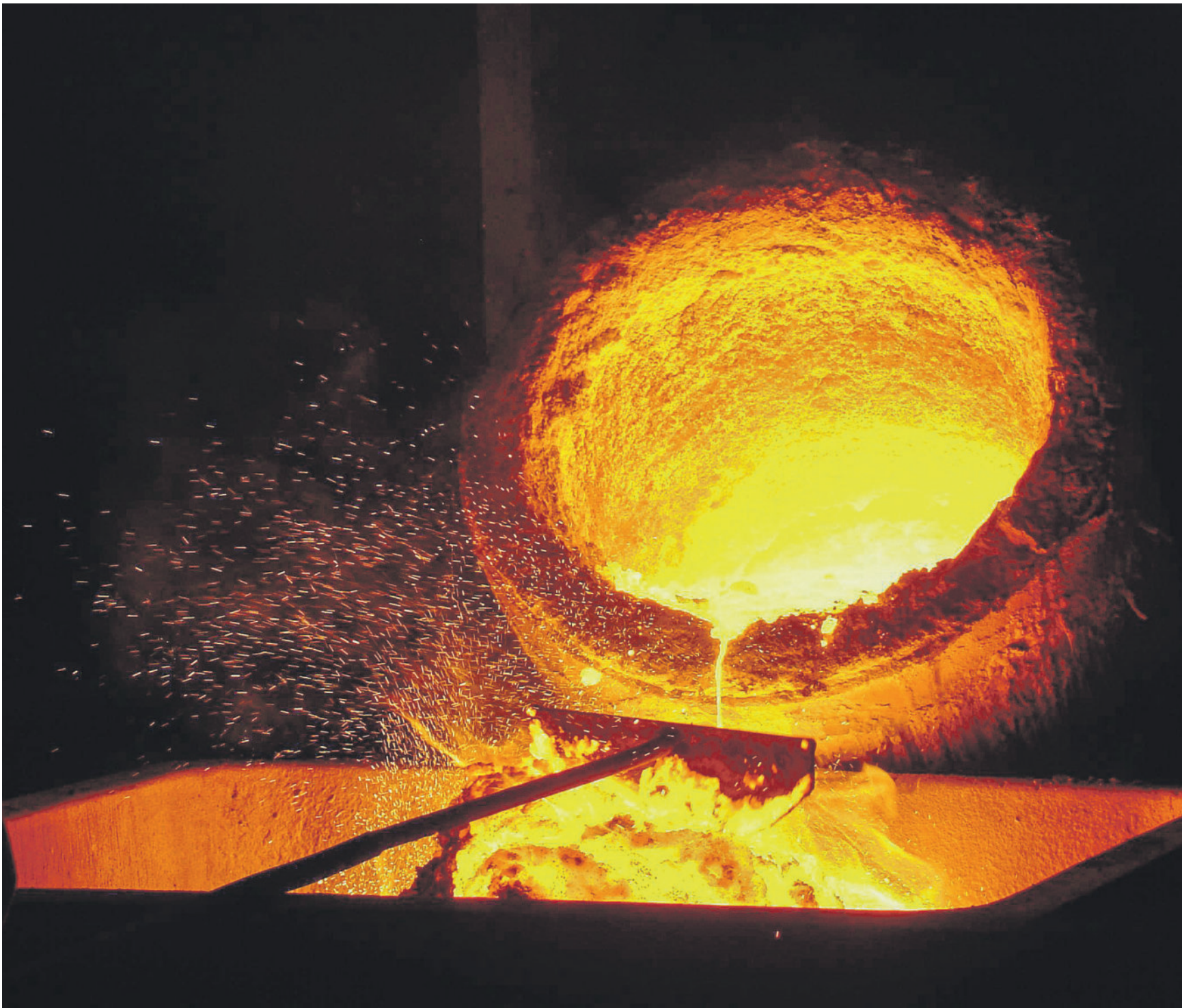
In der Giesserei Nottaris werden pro Tag bis zu 25 Tonnen Eisen im 1400 Grad heissen Ofen verarbeitet und für das Giessen bereitgestellt.
