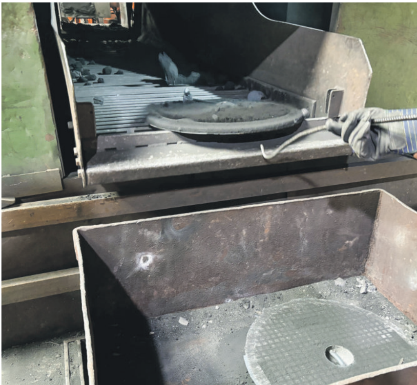
Ein fertiger Schachtdeckel kommt aus der Produktion.
